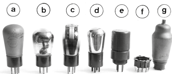
Fig. 13 - válvulas de origem europeias, Philips, fabricadas entre 1923 e 1933: a) tipo E42N, triodo. b) tipo C433, triodo. c) tipo 506, retificadora de onda completa. d) tipo C509, triodo amplificador. e) tipo A414K, triodo detector, com invólucro metálico blindado. f) soquete com contato lateral, feito em baquelita, muito conhecido no Brasil como Bigode de Gato. g) tipo AK2, octodo conversor
