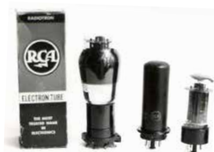
Fig. 15 - ilustração de três tipos do primeiro tetrodo de feixe dirigido, tipo 6L6, fabricado pela RCA nos EUA.
