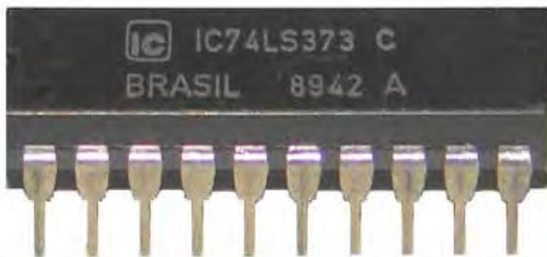
Fig. 479 - Circuito Integrado low Schottky tipo IC 74LS373 de fabricação nacional "Itaúcom".
