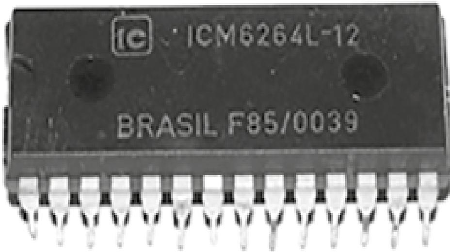
Fig.464 – Memória “RAM”, estática e assíncrona de 8192 palavras x 8 bits, com alimentação de 5 V com baixa corrente de ativação de 3 mA e, tempo de acesso de 150 nano segundos. Devido ao seu baixo consumo, o tipo 6264L é indicado para aplicações onde se exige uma memória não volátil alimentada por baterias de back up quando em modo standby.
