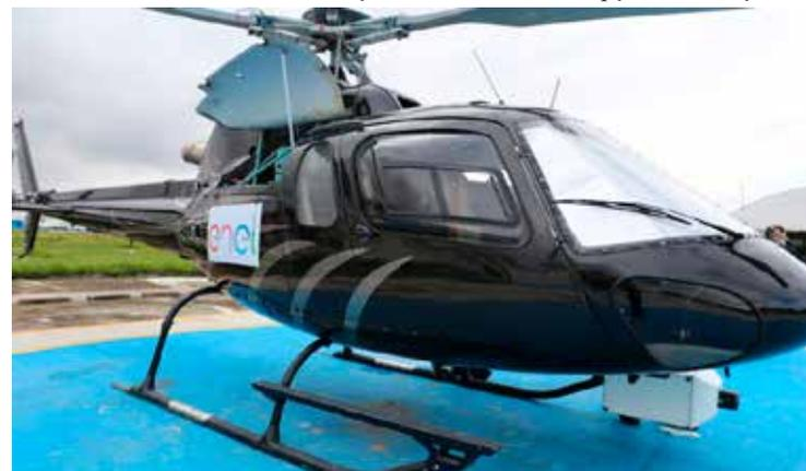
O helicóptero possui aparelho de tecnologia LIDAR (da sigla inglesa Light Detection And Ranging), que é capaz de produzir um modelo 3D da rede inspecionada.
