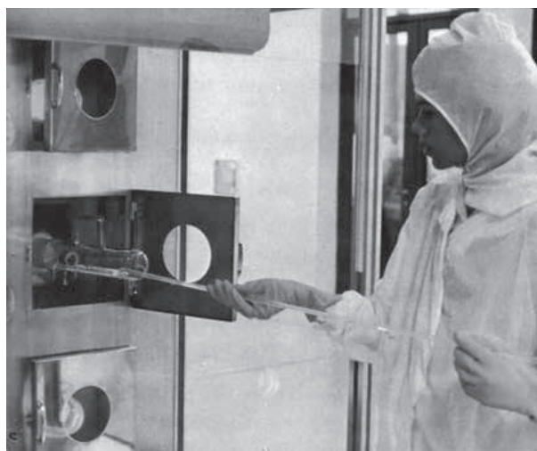
Fig.442 – Técnico operando um dos fornos de difusão, um dos processos da fabricação de transistores usando da tecnologia epitaxial “PLANAR”, nas dependências da empresa “Transit” em 1976. Fonte: revista Antenna.
