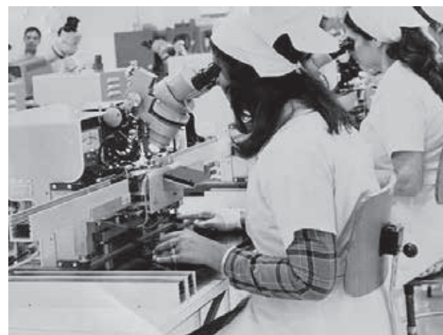
Fig. 445 – Detalhe da linha de montagem de semicondutores.
