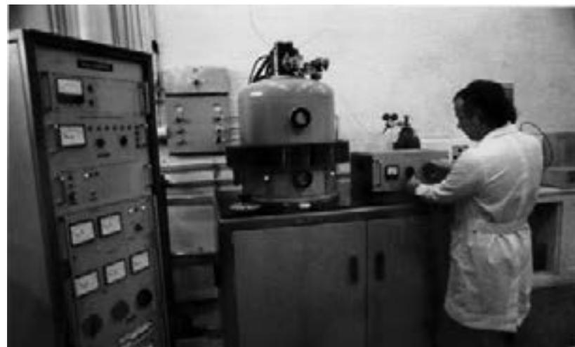
Fig.439 – O professor assistente operando um equipamento para metalização de substrato ou wafer usando a técnica do sputtering.
