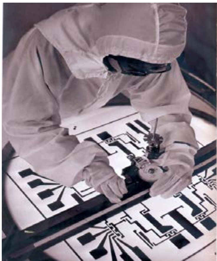
Fig. 436 – O coordenatógrafo manual ou mesa de projeção de precisão. Ela possui um cabeçote de gravação que pode ser posicionado ao longo de dois eixos perpendiculares para edições ou cortes de alta precisão.
