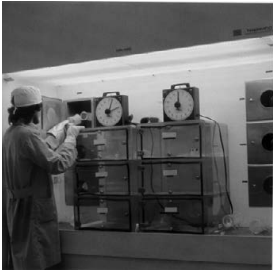
Fig.434 – O professor estagiário operando o forno onde o silício quando aquecido em presença de O 2 forma uma efetiva barreira de difusão.
