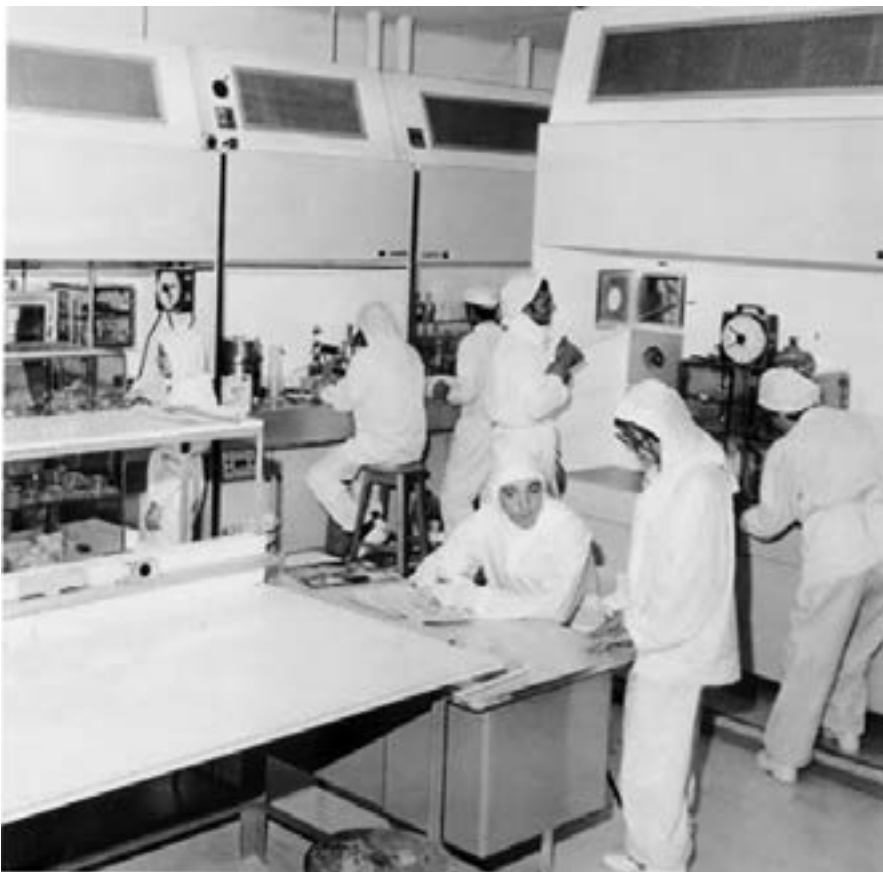
Fig.430 – O rígido controle ambiental do processo de fabricação de semicondutores exigia que a operação dos aparelhos e do manuseio de componentes fosse feita em salas limpas isentas de particulado aéreo, e, com preciso controle climático.
