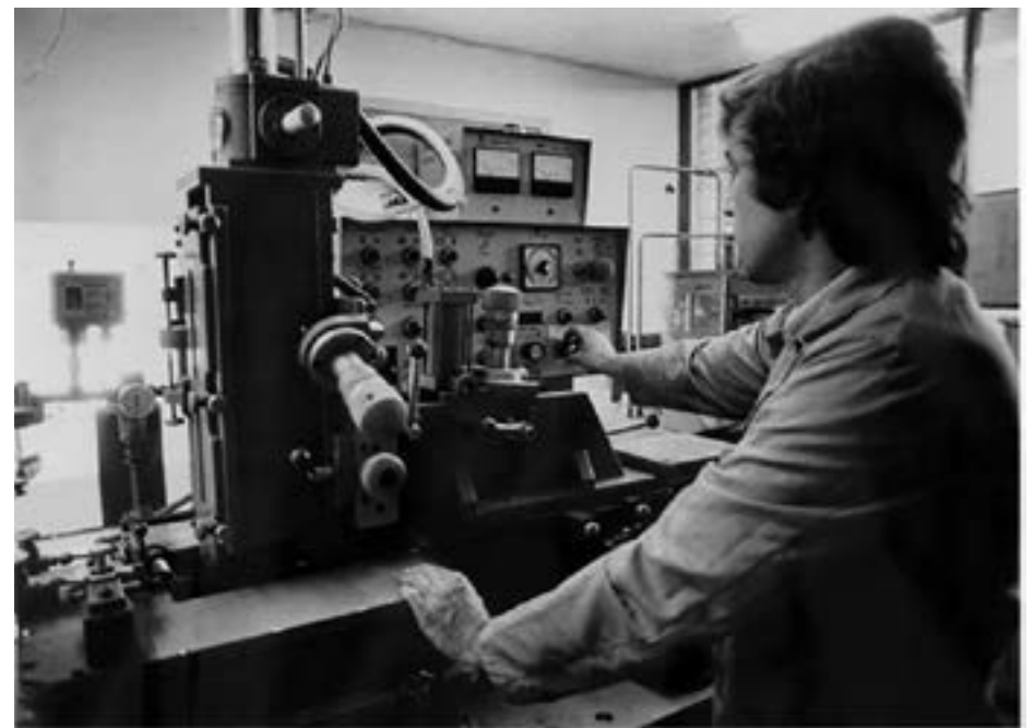
Fig. 431 – Após a obtenção do lingote de silício o passo seguinte é a obtenção da camada epitaxial, formada pelo aquecimento do substrato ou wafer a uma temperatura de 1200°.
