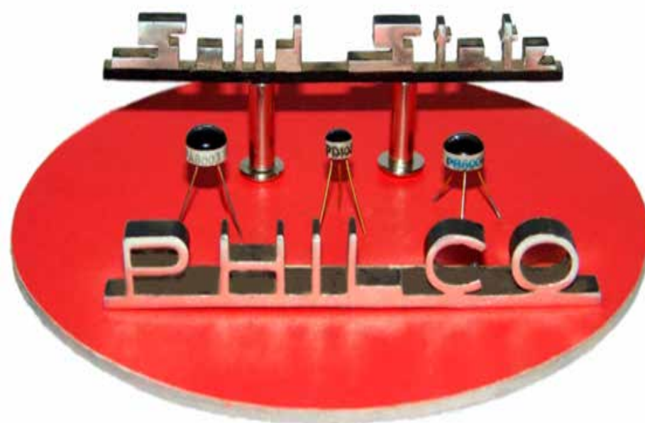
Fig.413 – Transistores fabricados pela empresa “Philco” usando da tecnologia epitaxial “PLANAR” prontos para comercialização. Na ilustração os tipos: PA 6003 - PD 1001 PB 6004, respectivamente para aplicações em estágios de pré-amplificação, sincronismo de vídeo, controle automático de ganho e áudio amplificação
