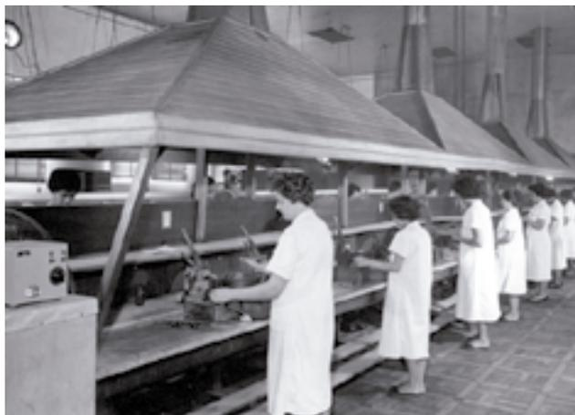
Fig.392 O estágio de produção de invólucros de capacitores.
