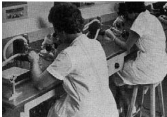
Fig. 382 – O delicado processo de posicionamento e soldagem dos contatos do semicondutor; operação que demanda o auxílio de estereó-zoom-microscópios.
