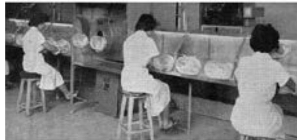
Fig. 381 – um dos processos de montagem do semicondutor sendo feita em câmeras secas para evitar contaminação por contágio dos seus delicados componentes estruturais. Fonte: revista Antenna.
