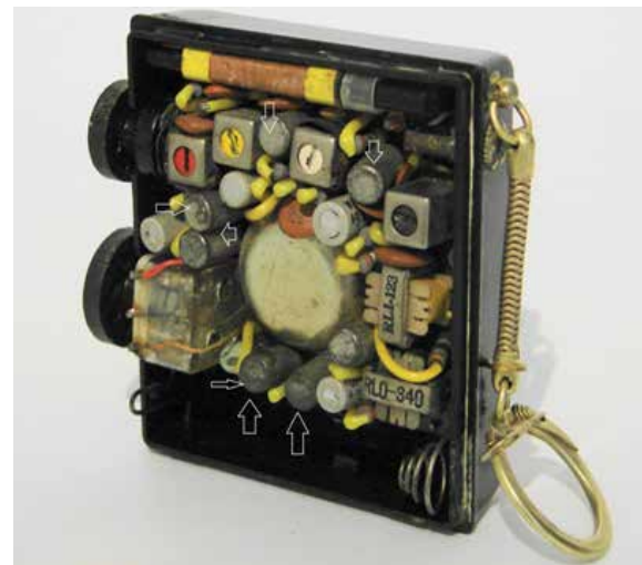
Fig.373 - Vista mostrando o conjunto do circuito do receptor modelo ST 711 composto por sete transistores já usando da codificação EIAJ para os tipos: 2SA201, 2SA202, 2SB 270, 2SB 186, 2SB 187, 2SB 187 os quais são indicados pelas setas na ilustração.
