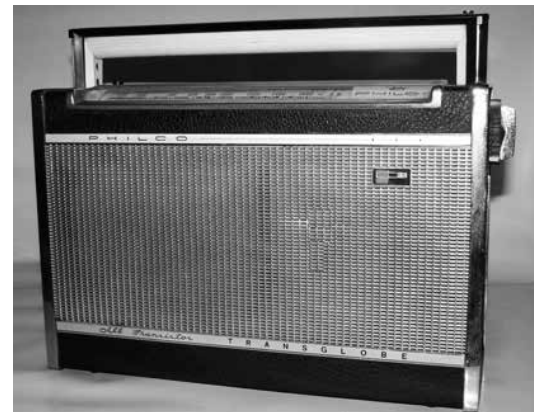
Fig. 355 — O imponente receptor modelo B-471, da linha "Transglobe", fabricado pela "Philco Rádio e Televisão Ltda." Nos meados da década de 1960. O alto-falante e circuito totalmente transistorizado alimentado por seis baterias tipo D2 é montado em gabinete metálico com acabamento em vinil preto. Sua sensível antena telescópica permite a precisa sintonia das estações nas faixas de frequências para AM, 550 - 1600 kHz e ondas curtas para 90 - 60 - 49 - 31 - 25 - 19 - 16 metros as quais são selecionadas por tambor rotativo e indicadas no dial horizontal com retroiluminação comutável no topo do gabinete.
