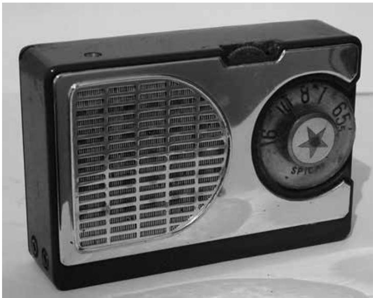
Fig. 348 – Rádio receptor “SpicaTransistor Six ST 600 A”, fabricado pela empresa japonesa “Sanritsu Electric Co., nos meados da década de 1950. O modelo ST 600 A é montado em um atraente gabinete de plástico com 125 x 83 x 35 mm, incorporando circuito super-heteródino, alimentado por 4 pilhas AA, o alto-falante dinâmico de 2,8 polegadas, a antena de ferrita para sintonia em ondas medias, de 540 – 1600 kHz.
