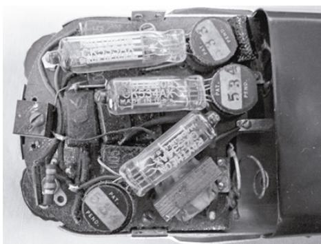
Fig. 345 – Ilustração do circuito elétrico de um aparelho de surdez usando válvulas subminiaturas tipo CK 5334 AK, fabricadas pela empresa Raytheon, EUA. A série de válvulas CK foram sendo gradativamente substituídas pelo transistor de junção tipo CK 718 o primeiro semiconductor fabricado em série por esta empresa.
