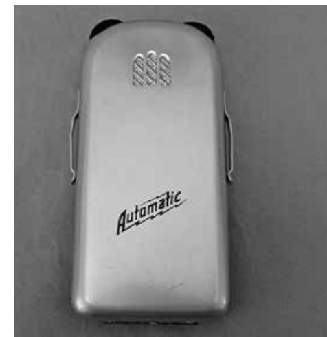
Fig. 344 – Um aparelho de surdez de origem norte-americana, usando válvulas subminiaturas em seu circuito elétrico.
