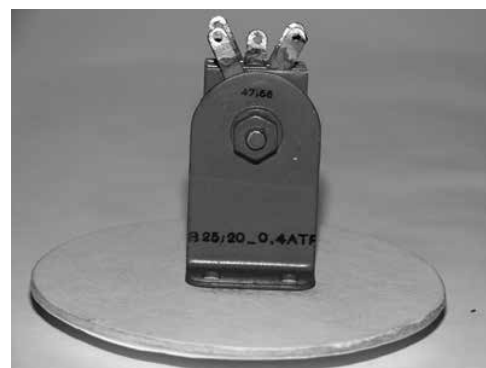
Fig. 343 – detalhe do suporte de fixação de um tipo de retificador de selênio.
