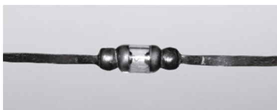
Fig. 333 – Ilustração de um antigo diodo de germânio tipo 1N34.
