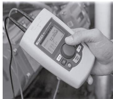
de controle inteligente se mova e, ao mesmo tempo, interpretar o sinal de retorno da válvula HART para determinar se a válvula está se movendo para a posição esperada. Além de informações sobre a posição, a pressão medida fornecida pelo I/P interno da válvula (que move a válvula) pode ser determinada através do protocolo de comunicação HART.
