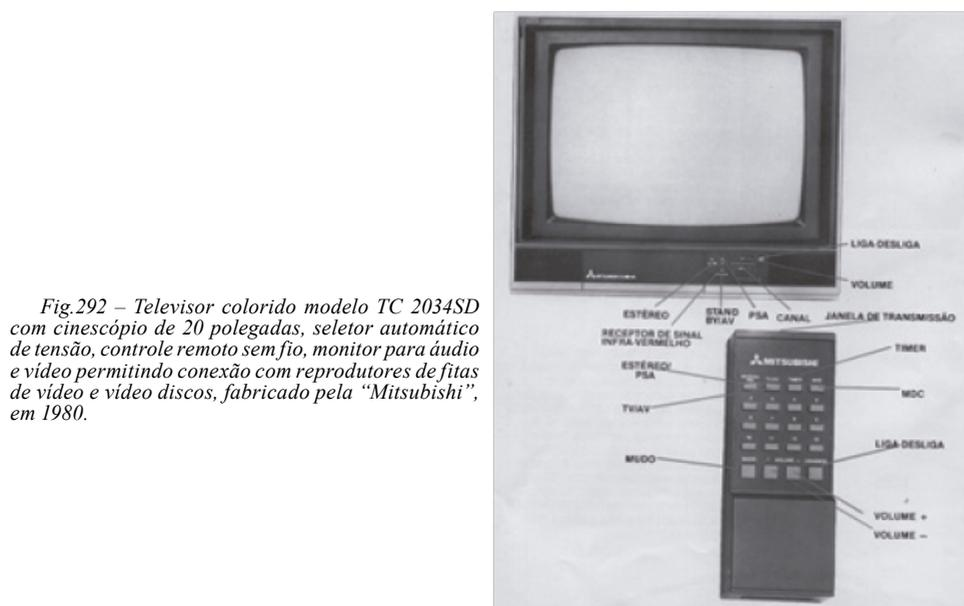
Fig. 292 – Televisor colorido modelo TC 2034SD com cinescópio de 20 polegadas, seletor automático de tensão, controle remoto sem fio, monitor para áudio e vídeo permitindo conexão com reprodutores de fitas de vídeo e vídeo discos, fabricado pela "Mitsubishi", em 1980.
