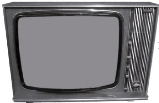
Fig. 289 – Televisor modelo DS 388, chassi B 76 2392-031, com cinescópio colorido de 26 polegadas, circuito transistorizado fabricado pela Philco-Ford nos meados da década de 1970.
