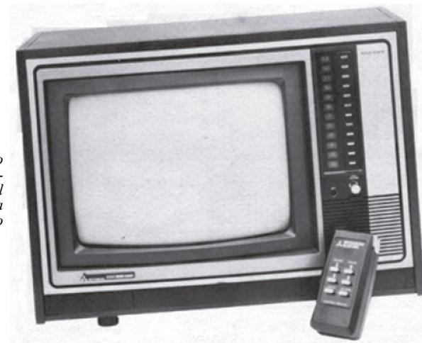
Fig. 294 – Televisor transistorizado a cores, com cinescópio de 14 polegadas "in Line", seletor de canal digital eletrônico com memória, sintonia fina automática (AFT), lançado no mercado brasileiro em 1982 pela Mitsubishi.
