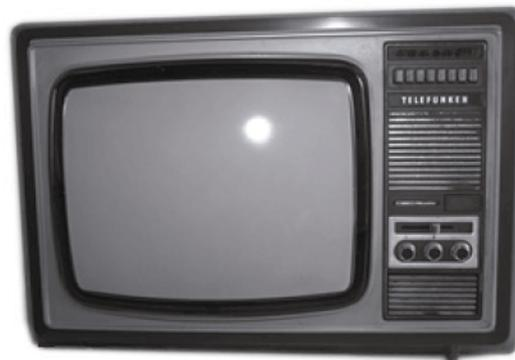
Fig. 293 – Televisor colorido, modelo TVC 364V, com cinescópio de 14 polegadas série "High-Light", com recepção em circuito automático "PAL-Telefunken", inibidor de cor automático interrompendo chuviscos e interferências na imagem na recepção de sinais em preto e branco e chassis basculantes em circuito impresso para facilitar a manutenção e ótima ventilação, montado em madeira de lei fabricado pela "Telefunken", no início da década de 1970.
