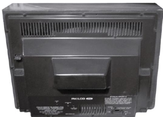
Fig. 291 - Vista traseira do televisor modelo DS 388, mostrando o anteparo de plástico preto fosco que ao ser removido permite o acesso ao cinescópio e circuitos elétricos do aparelho.
