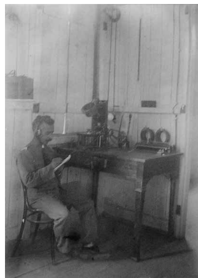
Fig.325 – Radiotelegrafista operando a estação de Senna Madureira, Alto Purus, Acre, inaugurada pela Repartição Geral de Telégrafos em julho de 1911, com indicativo de chamada SQN, usando sistema de transmissão com centelha sonora, fabricado pela empresa, “Gessellschaft für Drahtlose Telegraphie – System Telefunken – Berlin”, com área de cobertura de 500 km. Fonte: Siemens Historical Institute..
