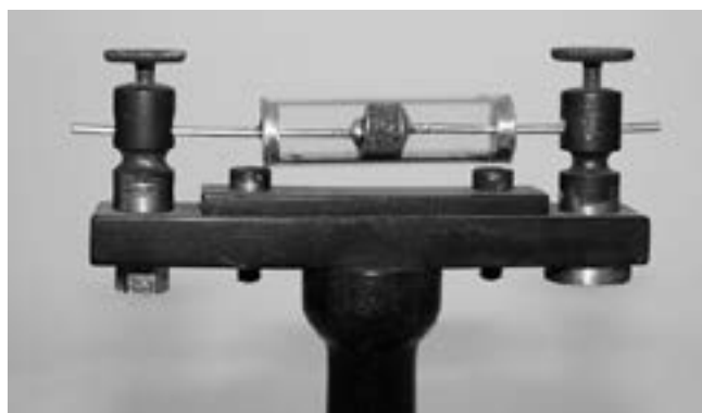
Fig. 303 – Réplica do coesor ou rádio-detector de Branly.
