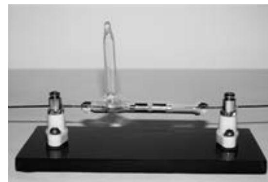
Fig. 305 – Réplica de um tipo de coesor ou rádio-detector de Marconi. O dispositivo consiste de um tubo de vidro de 60 mm de comprimento em cujo interior estão dois terminais de prata; o espaço entre eles é preenchido com limalha de níquel e prata.
